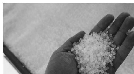
тель и «вдалбливают» в полимер, «затыкая» им дырки в структуре пластика. На выходе получаются вот такие гранулы – главный ингредиент сверхнадежной упаковочной пленки.
