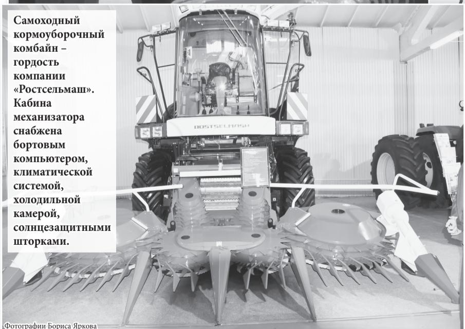
Самоходный кормоуборочный комбайн – гордость компании «Ростсельмаш». Кабина механизатора снабжена бортовым компьютером, климатической системой, холодильной камерой, солнцезащитными шторками.
