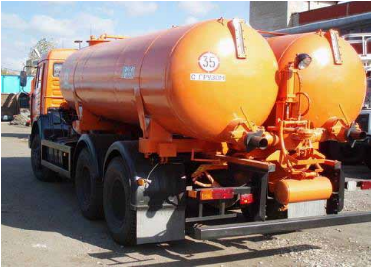
Рис. 5.3. Вакуумная машина КО-505А на шасси КамАЗ-65115-71
