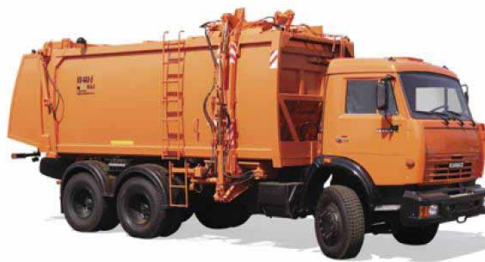
Рис. 4.22. Мусоровоз с боковой загрузкой КО-440-5 на базе шасси КАМАЗ 65115
