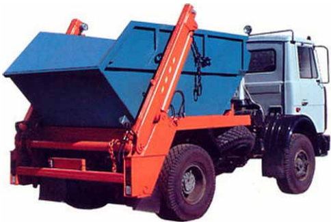
Рис. 4.23. Бункеровоз МКС-3501 на шасси МА3-5551А2
