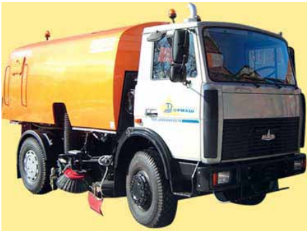
Рис. 7.8. Вакуумная подметально-уборочная машина ВПМД-01.
