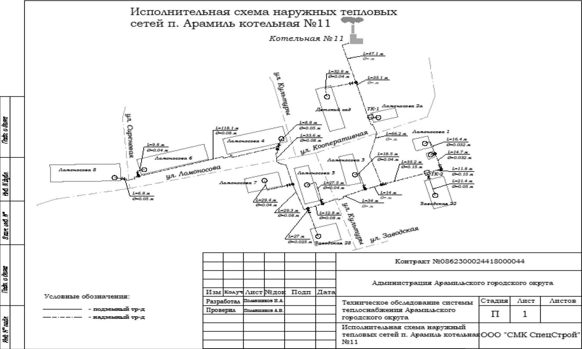
Рис. 27 – Исполнительная схема наружных тепловых сетей котельной №11
