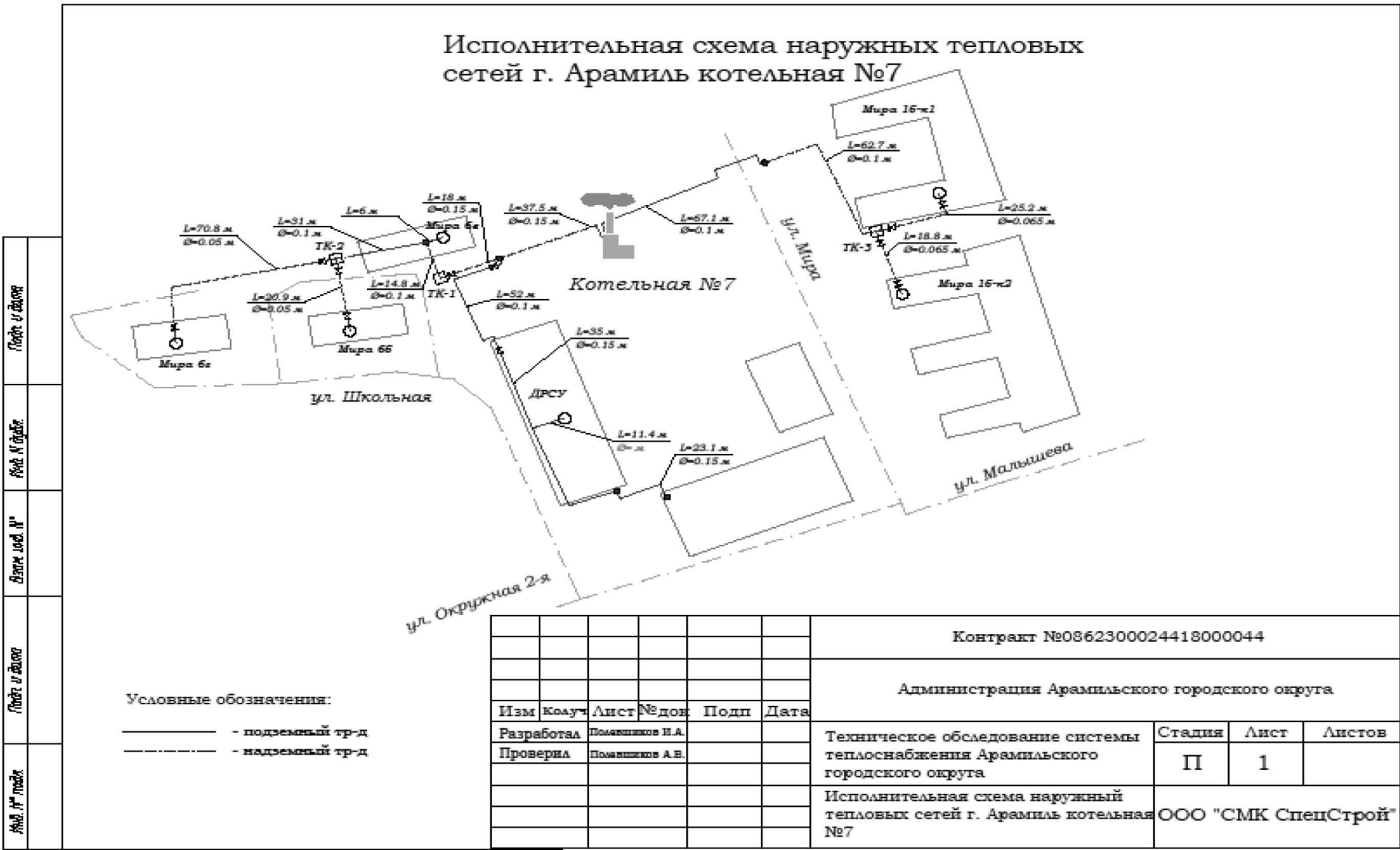
Рис. 21 – Исполнительная схема наружных тепловых сетей котельной №7
