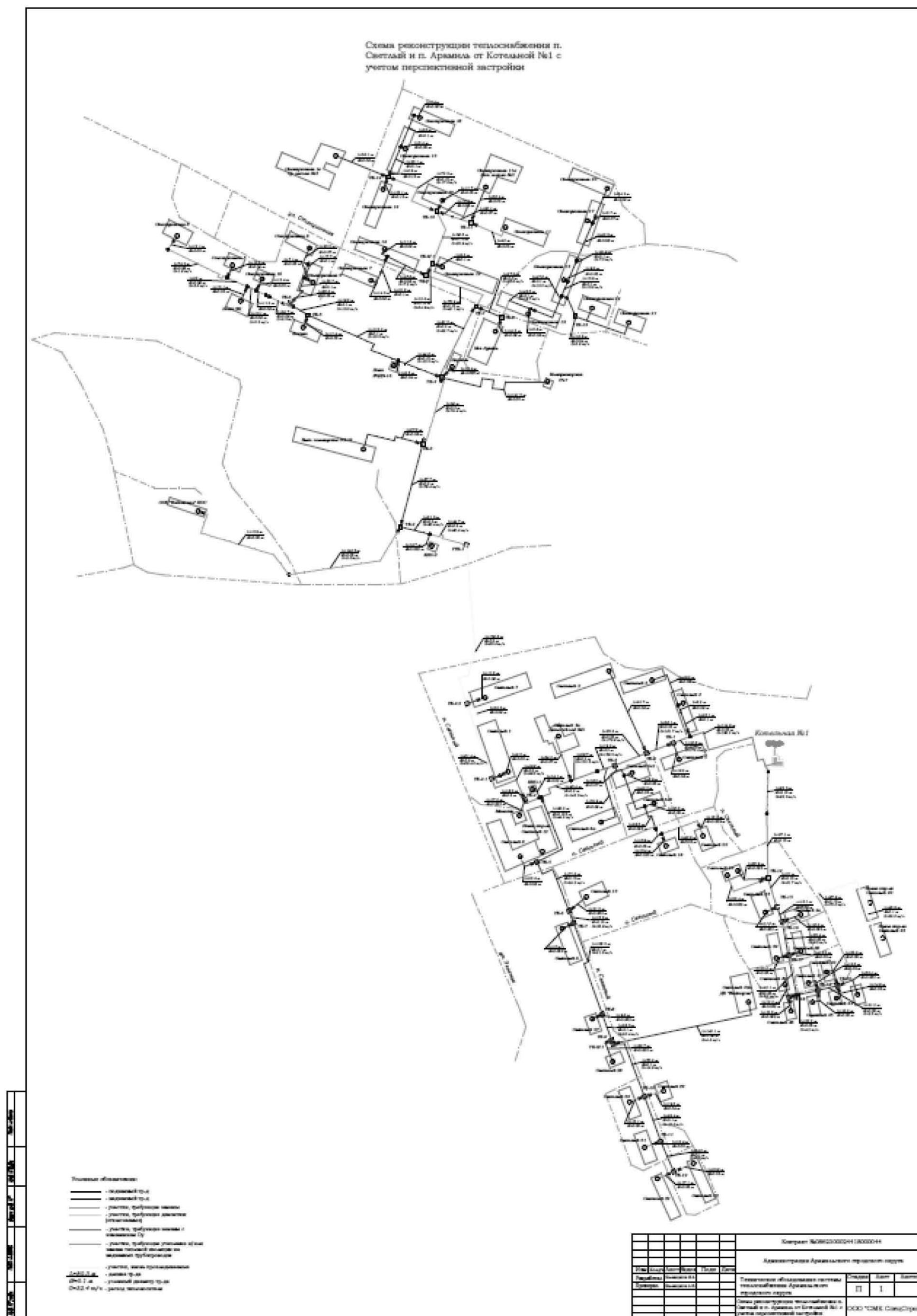
Схема 1 – Схема реконструкции теплоснабжения п. Светлый и п. Арамилы от котельной №1 с учетом перспективной застройки
