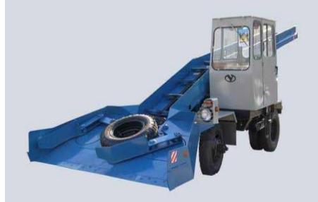
Рис. 7.10. Лаповый снегопогрузчик КО-206.
