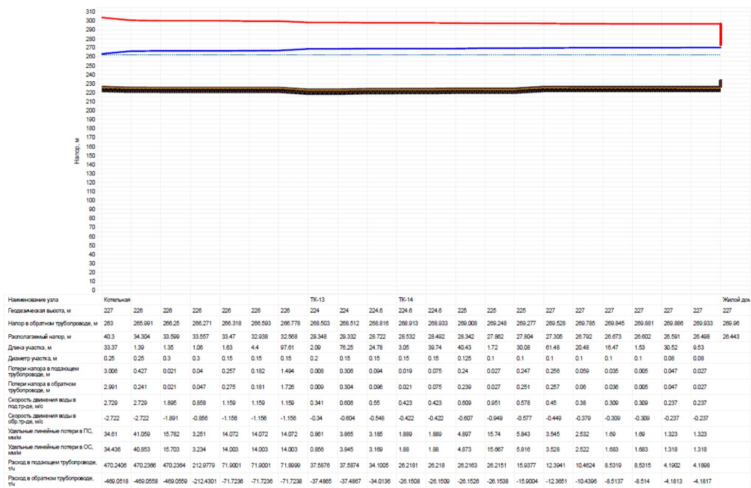
Рис. 23 - Пьезометрический график тепловых сетей котельной №8 от котельной до д. Курчатова, 12
